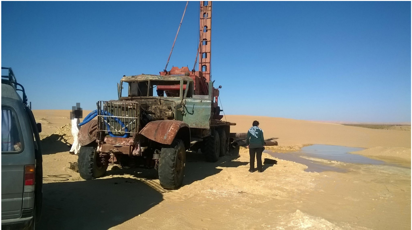
طريقة حفر الآبار بتقنية البركشن، تُستخدم في الأراضي المرتفعة المحيطة بسيوة منذ مطلع العقد الثاني للألفية © بدر الرفاعي
